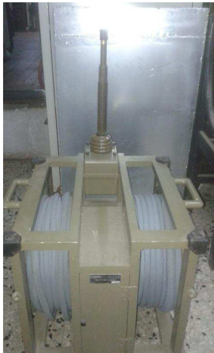
SX Antenna remota con sopra l'alloggio per l'accordatore automatico e i cavi di collegamento alla stazione - DX Ricetrasmittitore VHF Telettra RT 5 Hydra versione portatile
