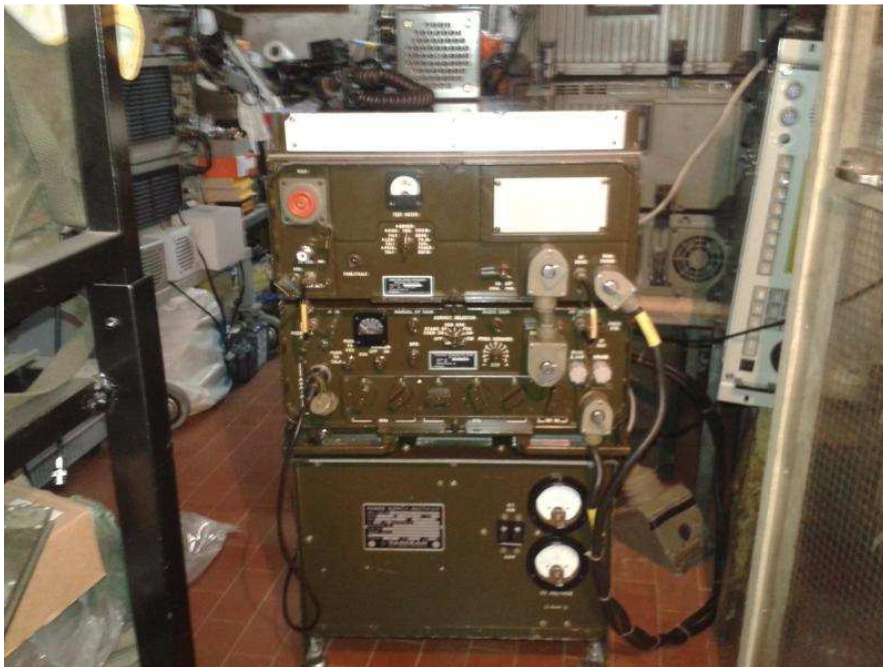
Stazione Ricetrasmittente HF AN/GRC 106 TA della Tadiran composta di amplificatore automatico AM 3349 TA, ricevitore/eccitatore RT 834/106A e alimentatore Tadiran.
