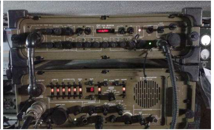
A destra Ricetrasmittitore Telettra HF M 400 composta da accordatore, lineare da 400 watt, alimentatore dal 220 volt, alimentatore dal 28 Volt, ricevitore/eccitatore, modem FSK e Controllo remoto. A sinistra Modem FSK Telettra
