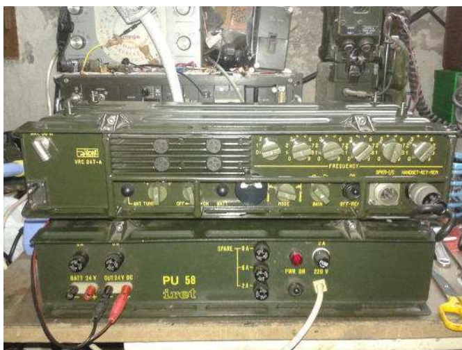
Ricetrasmittitore HF della Iret versione veicolare VRC 247/A con accordatore d'antenna remoto A DX SEM 80 in CONFIGURAZIONE a ponte con alimentatore tedesco e sistema di controllo AFKA
