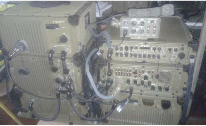
A destra Ricetrasmittitore Telettra HF M 400 composta da accordatore, lineare da 400 watt, alimentatore dal 220 volt, alimentatore dal 28 Volt, ricevitore/eccitatore, modem FSK e Controllo remoto. A sinistra Modem FSK Telettra
