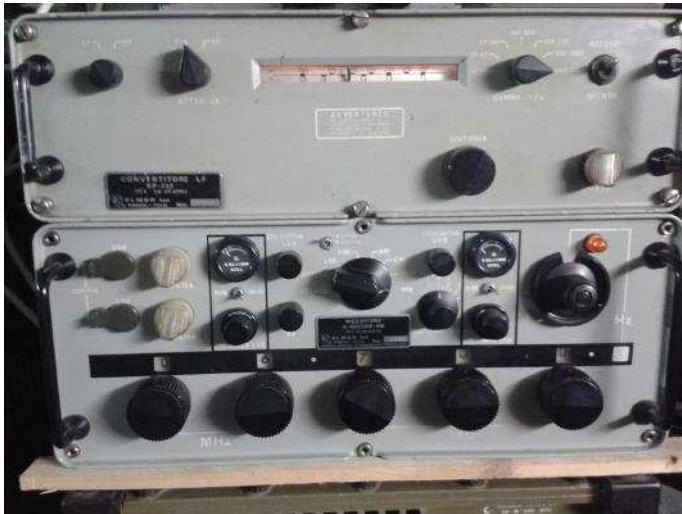
A destra Convertitore Elmer SP 263 - Ricevitore/Eccitatore del complesso AN / TRC 179, copre la frequenza HF composto dal RT 1512/G e controller 11670/G
