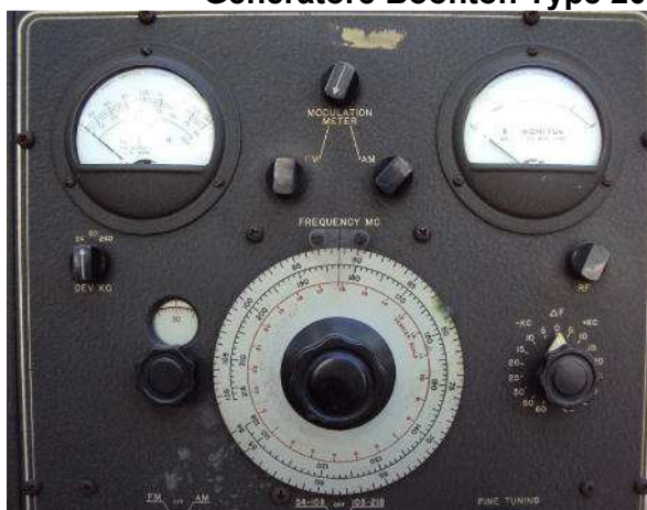
Generatore Boonton Type 202-0 completo del suo alimentatore
