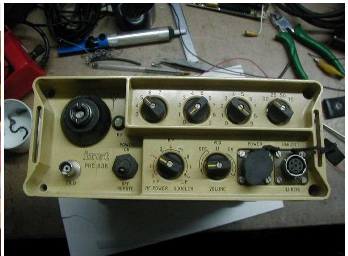
PRC 838 ed è la versione potenziata a 20 watt della PRC 638
