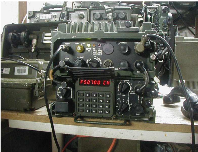
Ricetrasmittitore VHF Racal BCC 66 con Adattatore veicolare e lineare da 50 Watt
