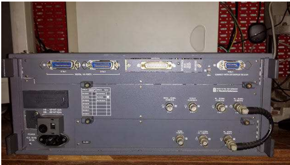
Pannello Posteriore con diversi terminali a cui è possibile attingere vari segnali a diverse Frequenze
