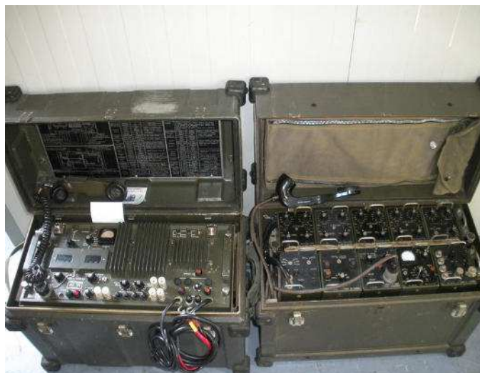
Ricetrasmittore VHF An / GRC 3 e 5 GRC versione italiana della Scialott Ponte radio Marconi MH 191 frequenza da 70 a 120 Mhz con Multiplex MX 155
