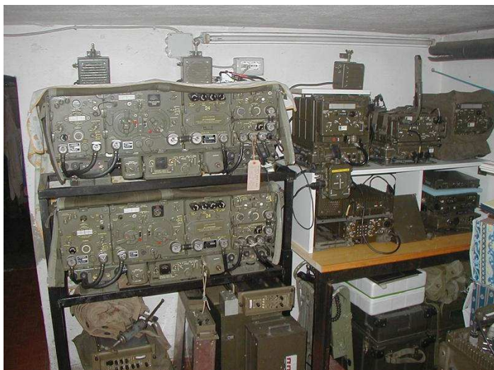
Ricetrasmittore VHF An / GRC 3 e 5 GRC versione italiana della Scialott Ponte radio Marconi MH 191 frequenza da 70 a 120 Mhz con Multiplex MX 155
