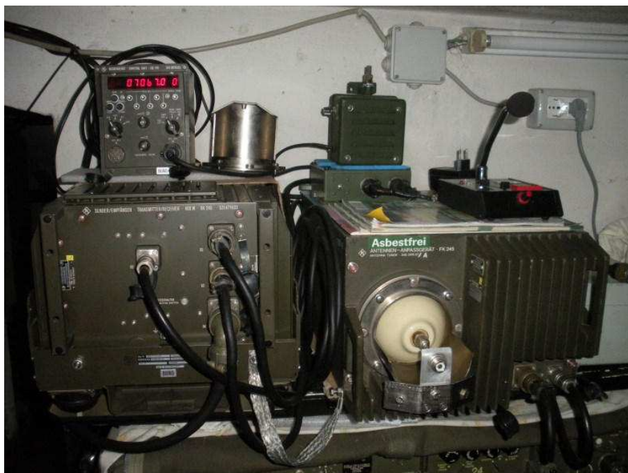
Ricetrasmittitore HF della Rohde & Schwartz XK 405 con adattatore autocostruito per aggiunta dell' LSB
