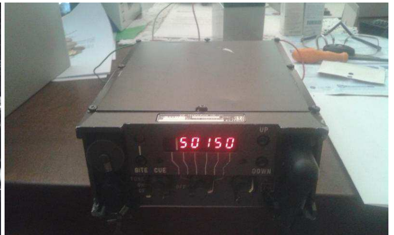
Ricetrasmittitore UHF Elmer RT 619 D - Ricetrasmittitore VHF ELMER ERC 321 da 30 a 90 MHz FM, ECCM, FH, Data
