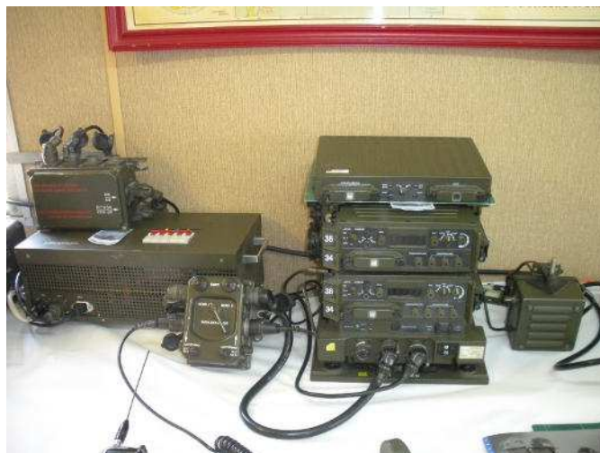
Ricetrasmittitore HF della Iret versione veicolare VRC 247/A con accordatore d'antenna remoto A DX SEM 80 in CONFIGURAZIONE a ponte con alimentatore tedesco e sistema di controllo AFKA
