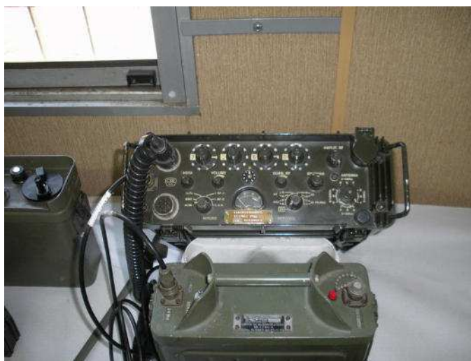
Ricetrasmittore italiano della GTE denominato Prc 1 oppure RH4/212, frequenza da 2 a 12 Mhz
