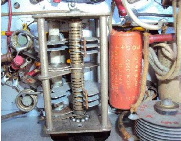
condensatore variabile con le bobine realizzate con grosso filo argentato
