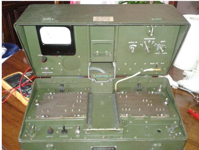
Attrezzo di prova per RV 3 Thomson CSF MR TX 14 A
