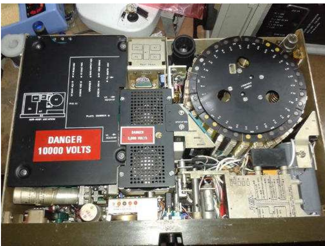
Interno dell'amplificatore TA
