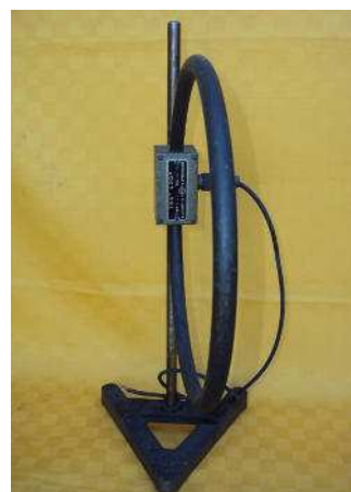
antenna Test per la calibrazione della sensibilità dei ricevitori
