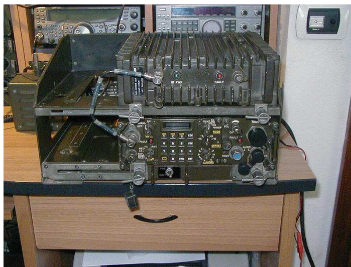
A sinistra SEM 35 con mounting, al centro Sem 25 e a destra il Ricevitore Em 25 con Impianto interfonico dedicato e moduli Comando Locale / Remoto A DX Ricetrasmittitore VHF della Tadiran Sait VRC 8000 completo di lineare da 50 watt
