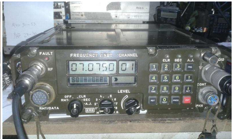
Ricetrasmittitore VHF della Tadiran Prc 80 versione portatile - Ricetrasmittitore HF della Tadiran PRC 2200 con modalità eecm e anti jamming
