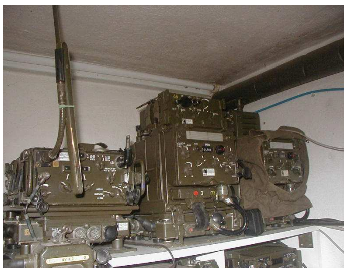
A sinistra SEM 35 con mounting, al centro Sem 25 e a destra il Ricevitore Em 25 con Impianto interfonico dedicato e moduli Comando Locale / Remoto A DX Ricetrasmittitore VHF della Tadiran Sait VRC 8000 completo di lineare da 50 watt
