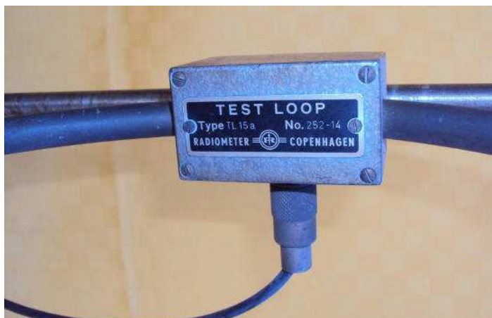
antenna Test per la calibrazione della sensibilità dei ricevitori
