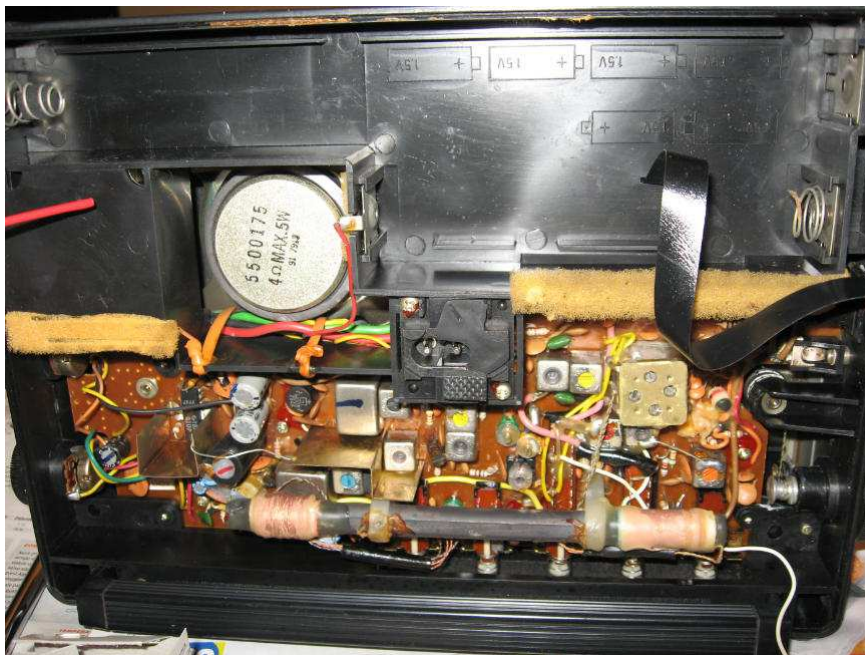
Panoramica interno POLO-ITT con in bella mostra gli avvolgimenti d'antenna su ferrite, invenzione Lorenz.
