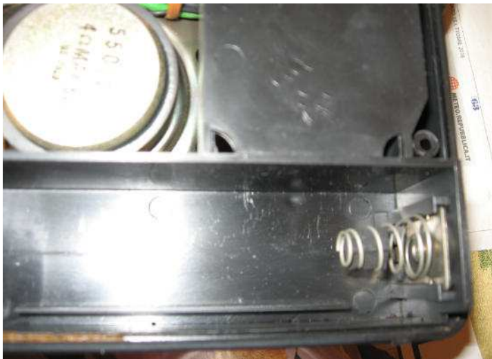
Disossidazione molla di contatto batterie.
