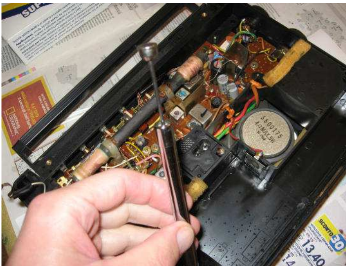
Antenna telescopica ripulita dall'ossidazione riposizionata in sede e bloccaggio vite con smalto trasparente.
