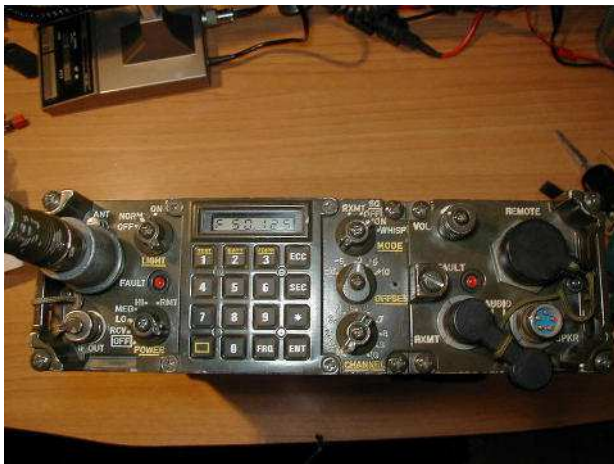
Ricetrasmittitore VHF della Tadiran Prc 80 versione portatile - Ricetrasmittitore HF della Tadiran PRC 2200 con modalità eecm e anti jamming
