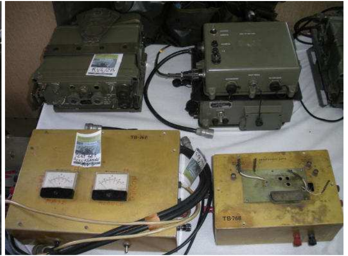
. Test box per analizzare radio RV3/4
