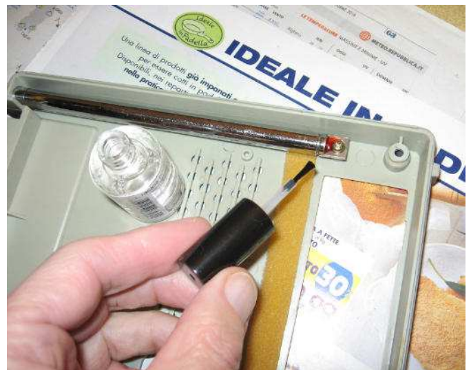
Antenna telescopica ripulita dall'ossidazione riposizionata in sede e bloccaggio vite con smalto trasparente.
