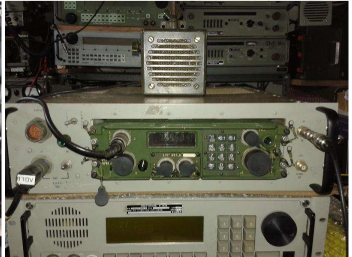
A destra Convertitore Elmer SP 263 - Ricevitore/Eccitatore del complesso AN / TRC 179, copre la frequenza HF composto dal RT 1512/G e controller 11670/G
