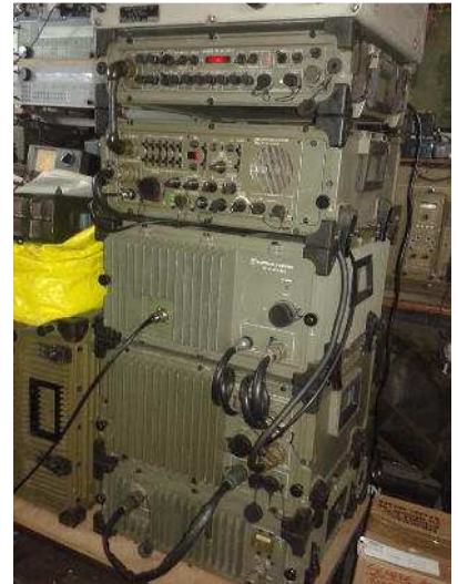
Complesso Telettra HF M 410 ultima versione collegata all'alimentatore Telettra HF M 400 DX Complesso HF Telettra M 410 montata in verticale
