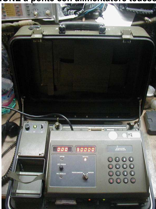
Copiatore e programmatore per i cassette memoria del sem 70/80/90 per il salto frequenza
