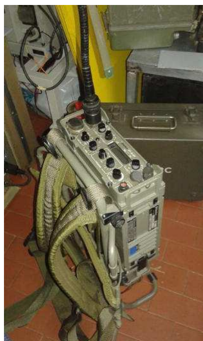
SX Antenna remota con sopra l'alloggio per l'accordatore automatico e i cavi di collegamento alla stazione - DX Ricetrasmittitore VHF Telettra RT 5 Hydra versione portatile
