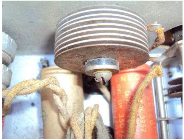
particolare del raddrizzatore al selenio
