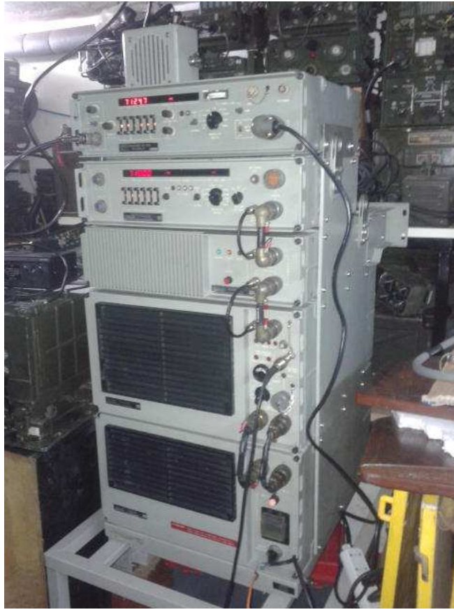
Sistema ricetrasmittente HF Elmer SRT 1075 composto da ricevitore, eccitatore, postselettore, amplificatore da 1 Kw ed in fine l'alimentatore.
